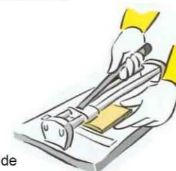
**Les découpes spéciales :** lorsque la coupe à effectuer n'est pas en ligne droite, utilisez une carrelette. La lame de section ronde permet de couper le carreau dans tous les sens.
